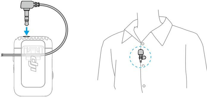
Befestige das Lavalier-Mikrofon am Kragen oder an der Vorderseite des Hemds, und stelle sicher, dass die Oberseite des Lavalier-Mikrofons 15 bis 20 cm vom Mund entfernt ist. Es wird empfohlen, das Mikrofonkabel an der Innenseite der Kleidung zu befestigen, um sicherzustellen, dass das Mikrofon an Ort und Stelle bleibt.
